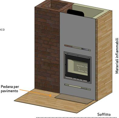
Queste piastre di copertura devono essere rimosse quando si esegue l'installazione dentro a materiale infiammabile protetto da isolamento
