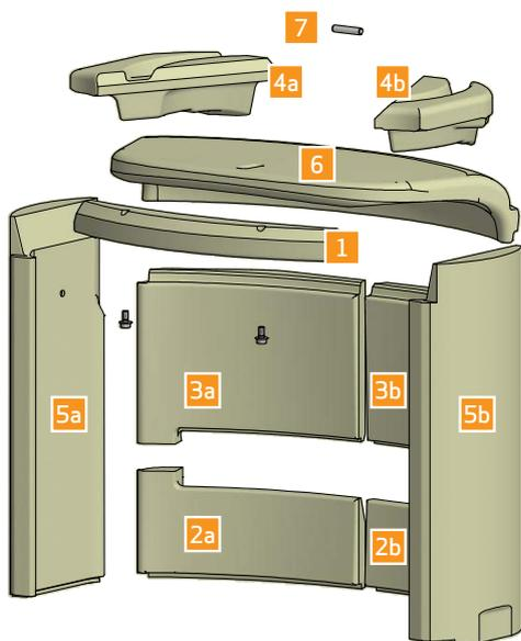
Montare la piastra in skamol 1 con le 2 viti
