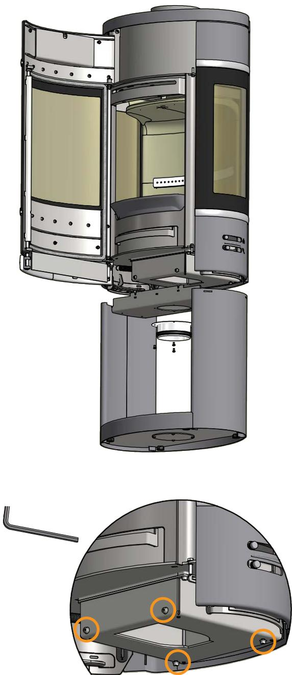
Una volta che la stufa è stata posizionata sulla base, le quattro viti devono essere rimontate
