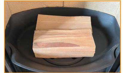
Nel test EN 13240 la stufa è stata fatta funzionare come in figura:
