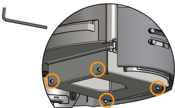
Una volta che la stufa è stata posizionata sulla base, le quattro viti devono essere rimontate
