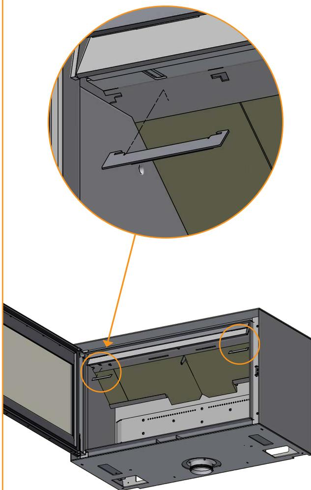
Montare la piastra deflettore fumi inferiore. La piastra deflettore deve essere sostenuta dalle piastre posteriori. Montare i perni e mettere in posizione il deflettore fumi
