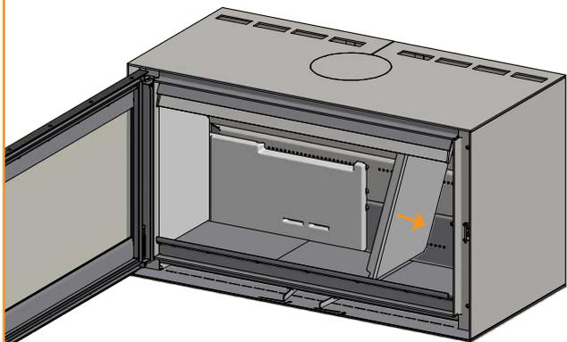
Le piastre posteriori della camera di combustione devono essere montate in modo che i fori delle piastre siano precisamente in posizione sopra i fori terziari della stufa
