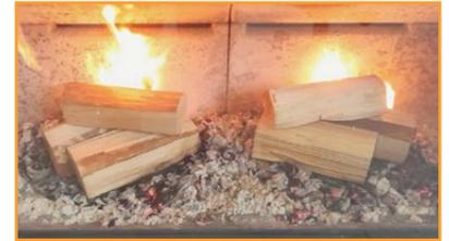
Nel test EN 13229 la stufa è stata fatta funzionare come in figura:
